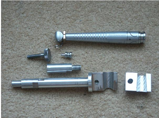
*Abb. 9: Laserhandstück und Handstückaufnahme zerlegt*
