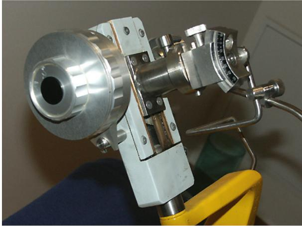
*Abb. 15: Höhensupport zur Aufnahme des Laserhandstücks mit Winkeleinstellvorrichtung*
