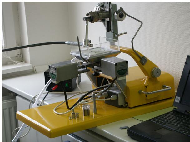
*Abb. 23: Versuchsanordnung in Arbeitsbereitschaft mit zu erkennender Winkelneigung der Laserhandstücksaufnahme*
