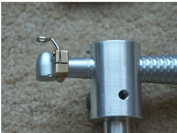
*Abb. 11: Detailansicht: Fixiertes Laserhandstück, einschließlich montierter Abstandführung*
