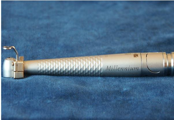
*Abb. 1: Konstruierte und montierte Kalibriereinheit auf dem einzusetzenden Laserhandstück. Übersicht Handstück, Winkel 90°.*
